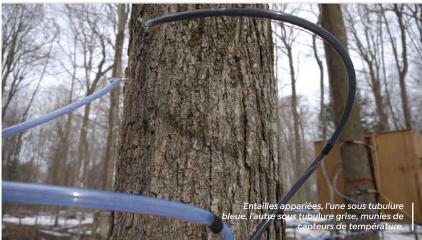
Entailles appariées, l'une sous tubulure bleue, l'autre sous tubulure grise, munies de capteurs de température.
