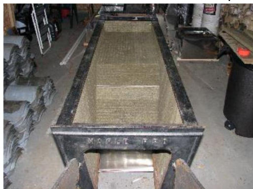
Panneaux isolants installés dans l'évaporateur
