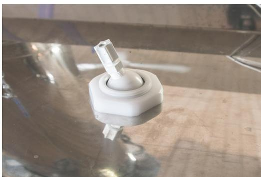
Dévissez l'écrou de l'adaptateur 1/4 afin de pouvoir insérer la sonde dans la rotule. Insérez la sonde dans la rotule jusqu'à ce que le bout de la tige soit à 2 pouces plus bas que le dessus de la division de la panne. Resserez l'écrou blanc.
