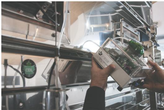
Percez **un trou de 2 pouces** sur la hotte à l'aide d'une perceuse ou d'un emporte pièce destinée à l'acier afin d'installer la rotule de la sonde à l'endroit où débute la montée de la mousse.
