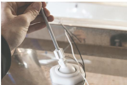
Fixer le fil de sonde (filage blanc) à la zone métallique de la sonde.
