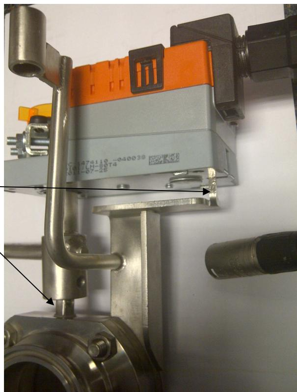
Insérer la tige du contrôleur dans le tube du support
