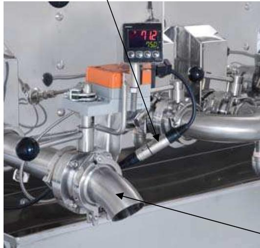
Il est recommandé d'installer au bout de la valve papillon, un coude. Il permet d'obtenir une sortie du sirop plus concentré et ça évite de faire des dégâts.
