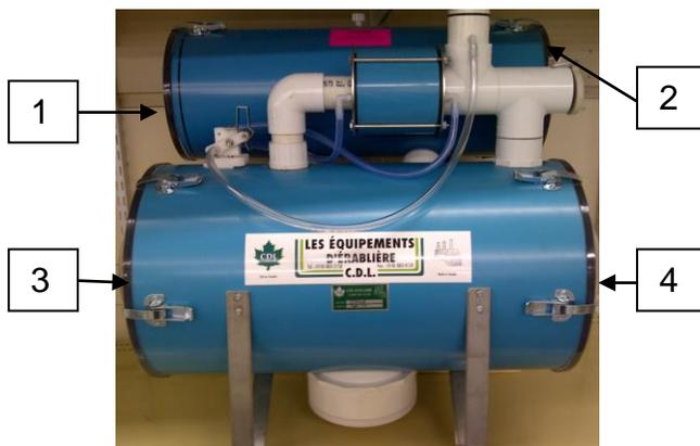
Aussi, pendant la saison, vaporiser du lubrifiant alimentaire sur la tige d'inox qui traverse la cuve principale. Ça va faciliter le mouvement de la tige.
