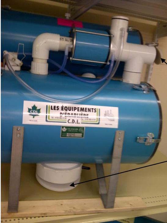
Le cylindre force l'ouverture de la trappe laissant entrer l'air dans la cuve, ce qui coupe le vacuum à l'intérieur
