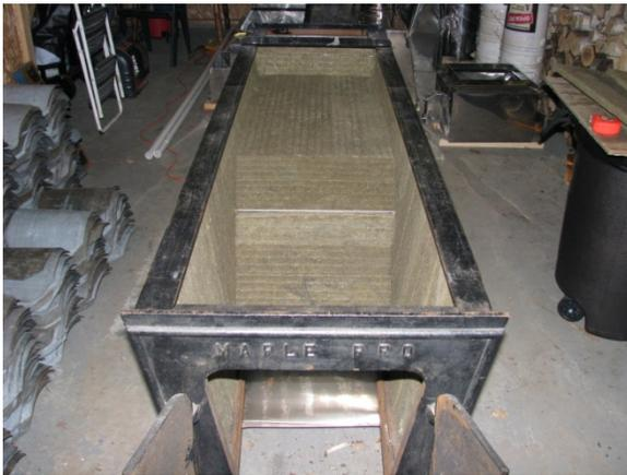
Panneaux isolant couvrant le fond de l'évaporateur
