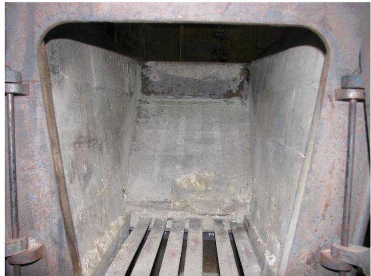
Photo d'un évaporateur briqué. Le ciment haute température est utilisé pour tenir les briques ensemble.
