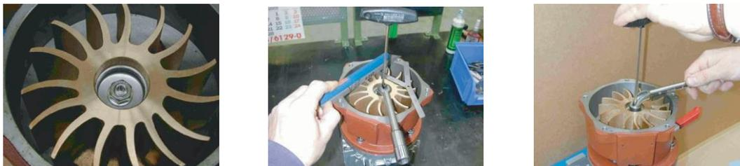
Ajustez l'impulseur avec la vis de réglage de l'impulseur. Il doit y avoir un espace de 0,1 à 0,15 mm entre la surface de l'impulseur et la surface du boîtier de l'arbre. Utilisez la règle en métal et la jauge d'épaisseur pour régler l'écart.
