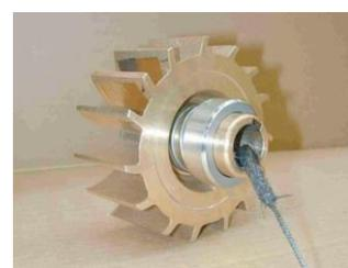
Mettre le joint mécanique (047) au-dessus de l'arbre de l'impulseur (230). Ne pas toucher la surface du joint mécanique. Enduire l'alésage de l'impulseur avec du molykote.
