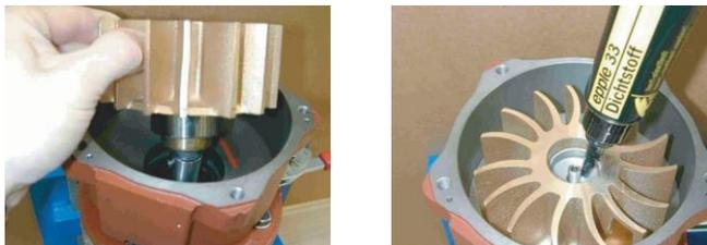
Enduire le disque de l'impulseur avec le liquide scellant (Epple).
