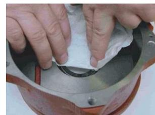
Installer le joint mécanique (047) dans le boîtier de joint d'arbre (441). Ne pas toucher la surface du joint mécanique
