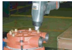
Installer le boîtier de la pompe (101) sur l'intérieur du boîtier (137). Enfiler les vis hexagonales (901). Serrer les vis (901) transversalement.
