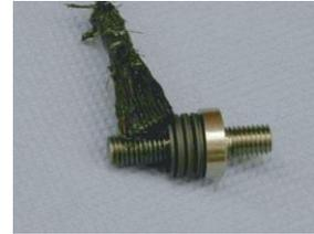
Installer les ressorts de distance (950, revêtus de molykote) sur la vis de réglage de l'impulseur (906). Soyez prudent car les ressorts de distance doivent être montés comme indiqué sur l'image ci-dessus. Enduire le fil de la vis de réglage de l'impulseur également avec le molykote.
