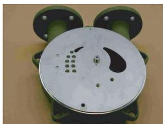
Installer l'intérieur du boîtier au boîtier de la pompe. La position correcte est donnée par la goupille du boîtier de pompe.
