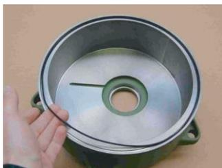
Installer le boîtier de la pompe (101) sur le boîtier de l'arbre (441)
